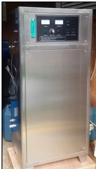
Figura 16. Fotografía del sistema de generación de ozono WTC S.A.S
