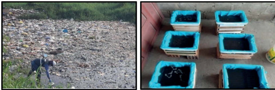
Figura 7. Recolección de los lixiviados del botadero / distribución del lixiviado en los estanques
