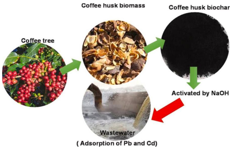
Figura 12. Proceso de obtención del adsorbente<sup>(41)</sup>
