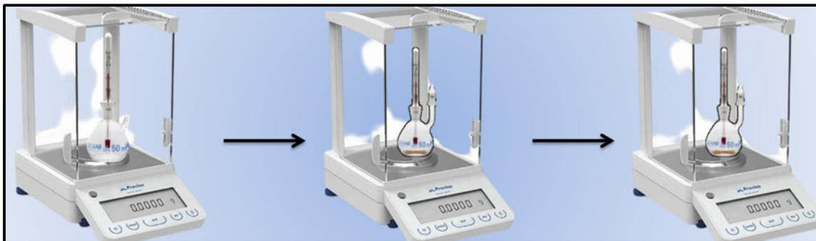
Figura 6. Procedimiento la determinación de la densidad real mediante el método del picnómetro<sup>(7)</sup>
